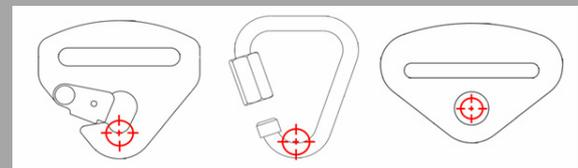
Ejemplos de puntos de rotación del anclaje de correa
